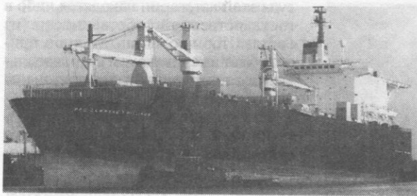
Рис. 4. Быстроходный грузовой транспорт «Гордон» (Т-АКР-296) типа «Зеландия», способный перевозить 58 танков, 48 гусеничных машин, 254 грузовых автомобиля и 666 легких колесных транспортных средств
